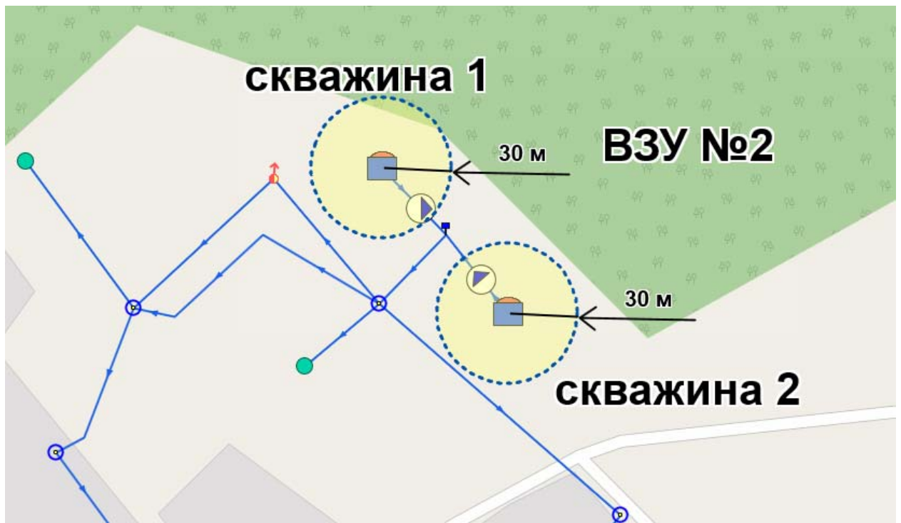
Рисунок 2.1.29. Схема дислокации водозабора ВЗУ №2 (п. Запрудня) с указанием границ ЗСО
