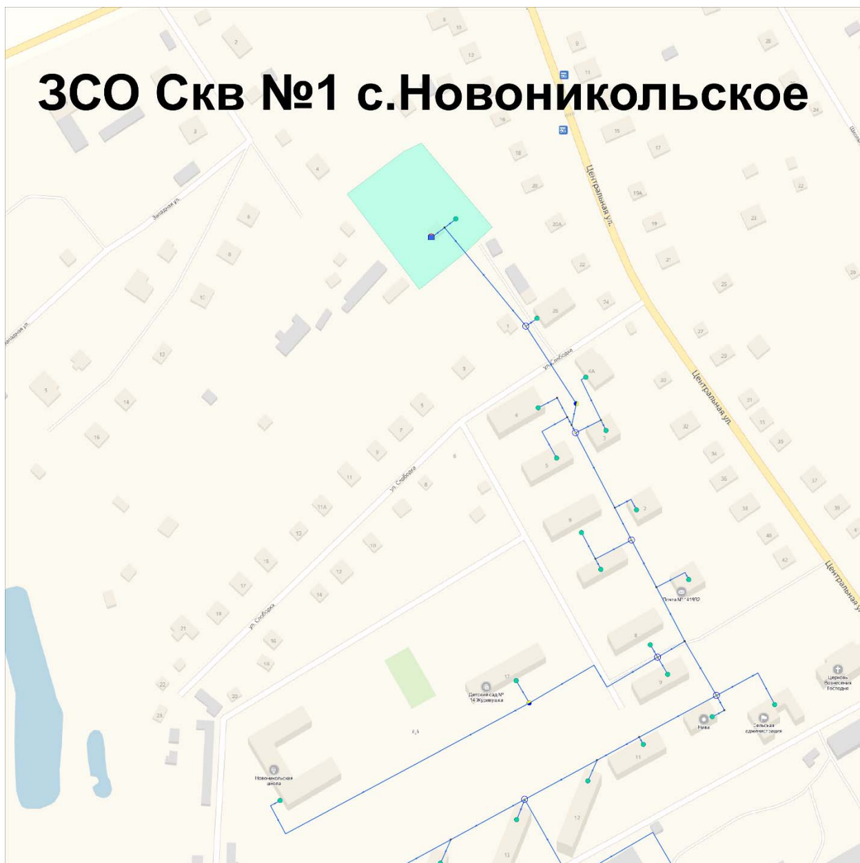
Рисунок 2.1.37. Схема дислокации водозабора ВЗУ №1 с. Новоникольское с указанием границ ЗСО
