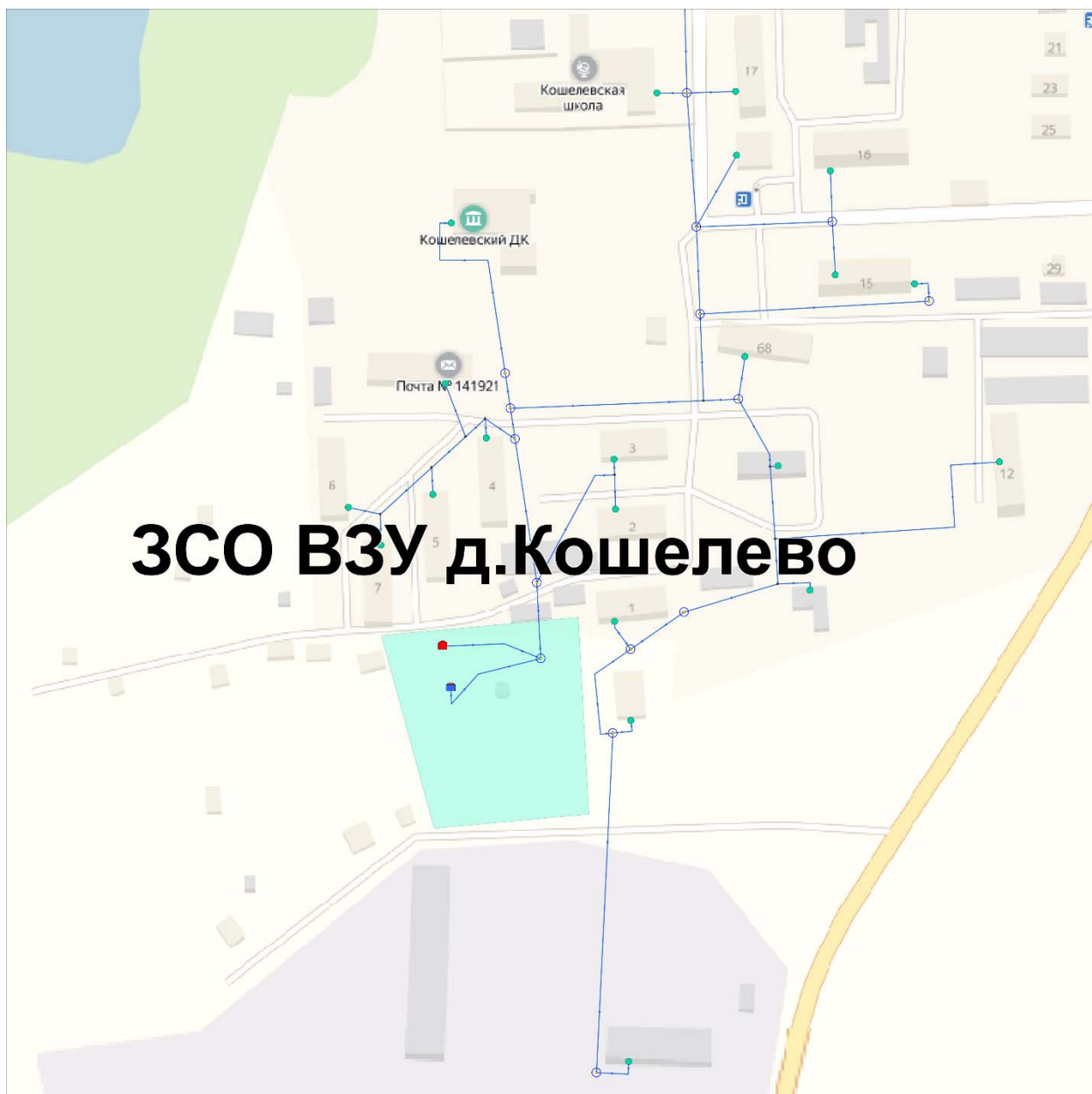
Рисунок 2.1.25. Схема дислокации водозабора ВЗУ д. Кошелево с указанием границ ЗСО
