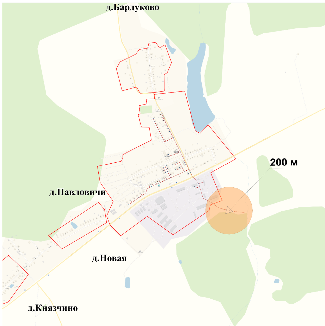
Рисунок 3.1.40. Схема дислокации очистных сооружений МУП «Талдомсервис» на территории д Павловичи, с указанием зоны санитарной охраны
