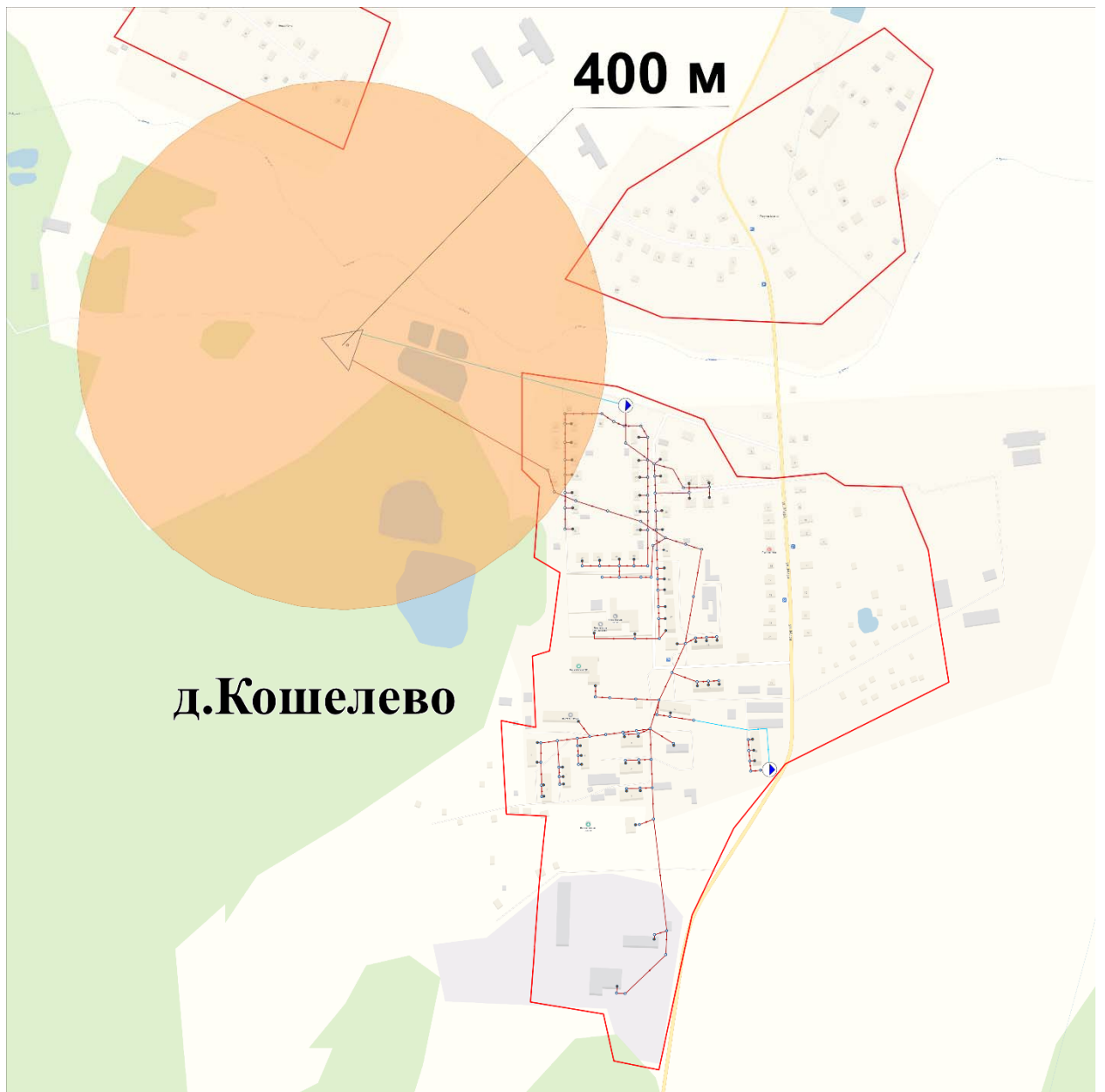
Рисунок 3.1.30. Схема дислокации очистных сооружений МУП «Талдомсервис» на территории д. Кошелево, с указанием зоны санитарной охраны
