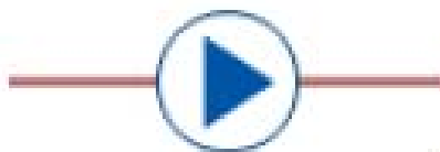
Рисунок 4.2.13. Графическое изображение канализационного насоса
