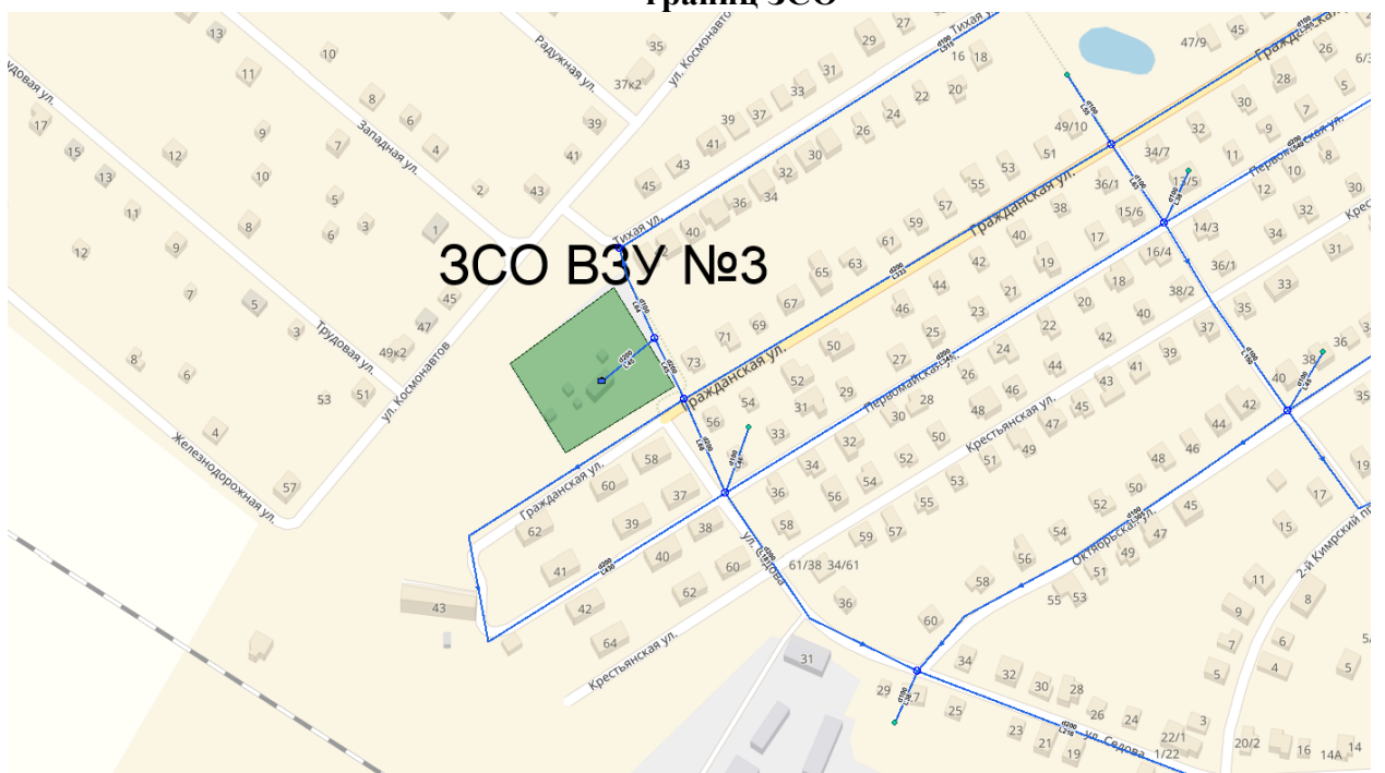
Рисунок 2.1.20. Схема дислокации водозабора ВЗУ №3 (г. Талдом) с указанием границ ЗСО
