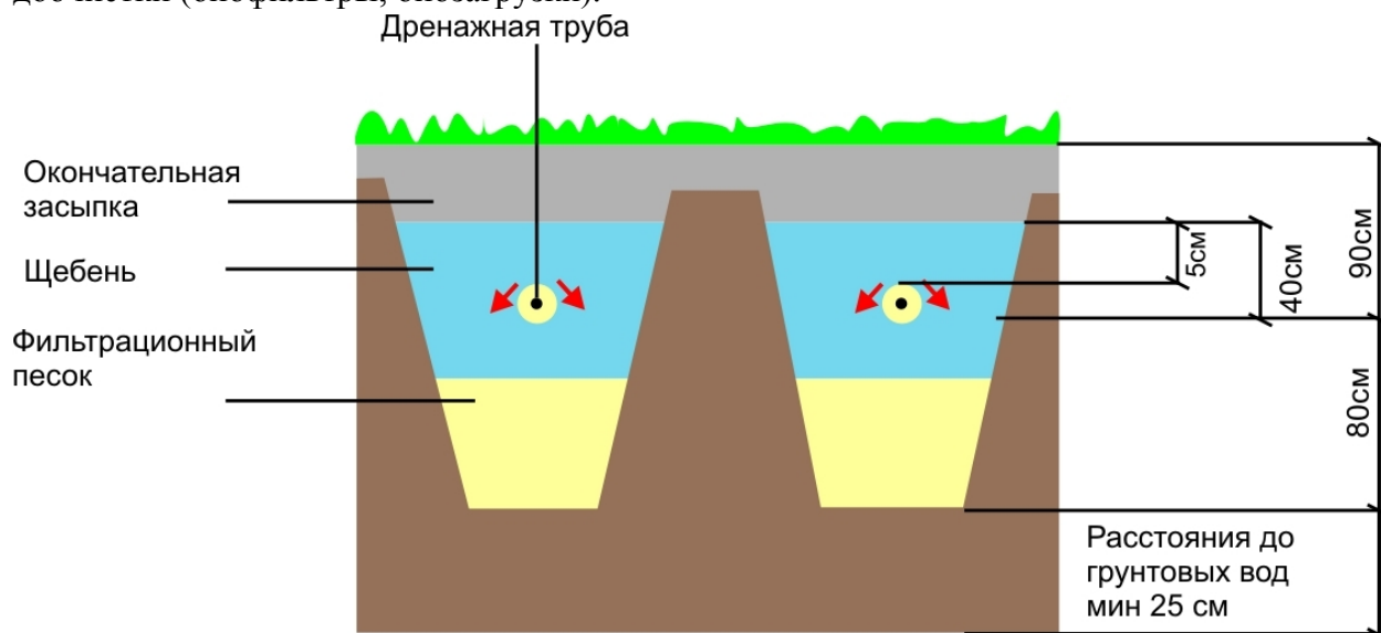
Рисунок 3.1.45. Технологическая схема ПФ д. Парашино
