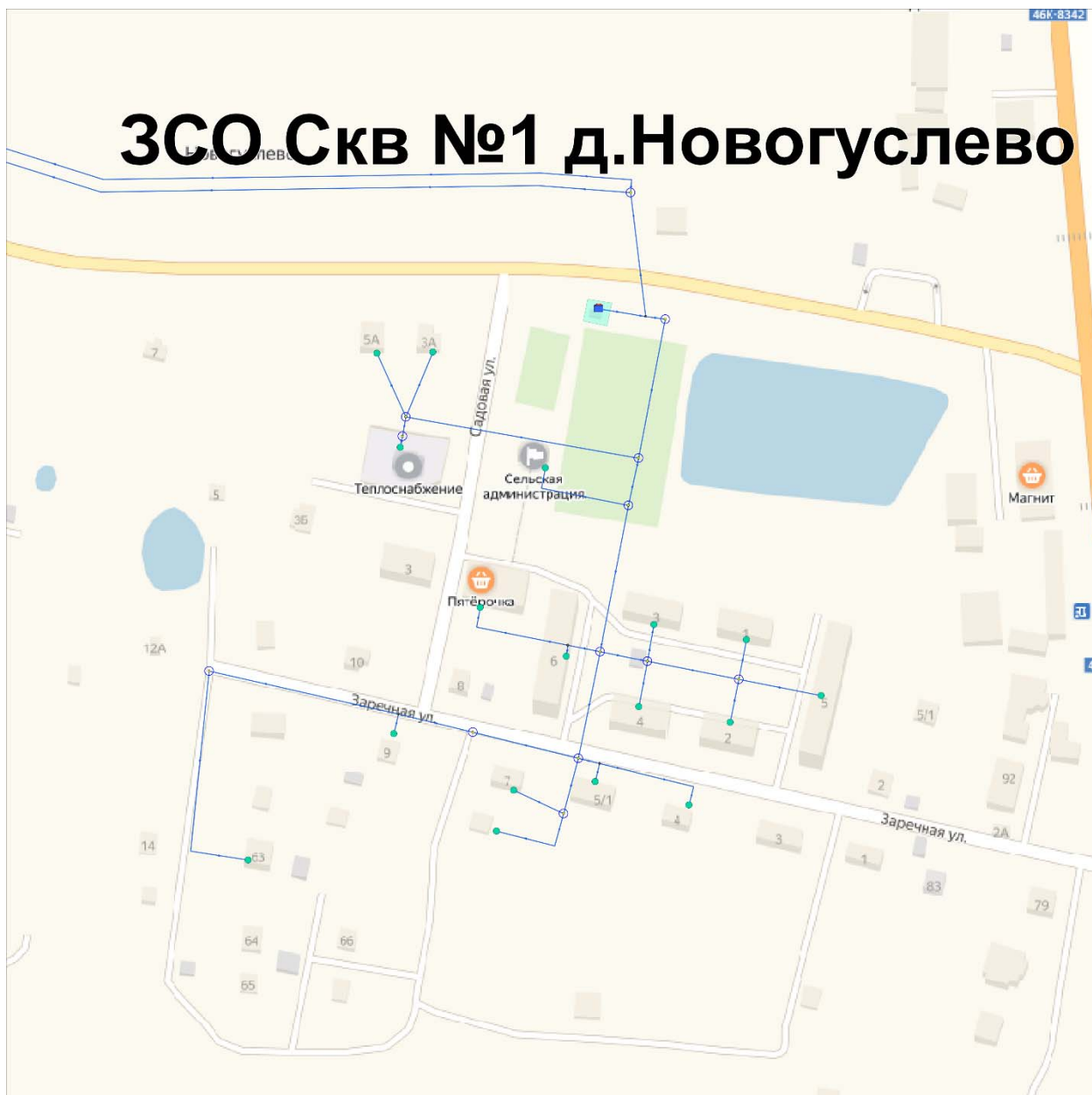
Рисунок 2.1.34. Схема дислокации водозабора ВЗУ д. Новогуслево с указанием границ ЗСО
